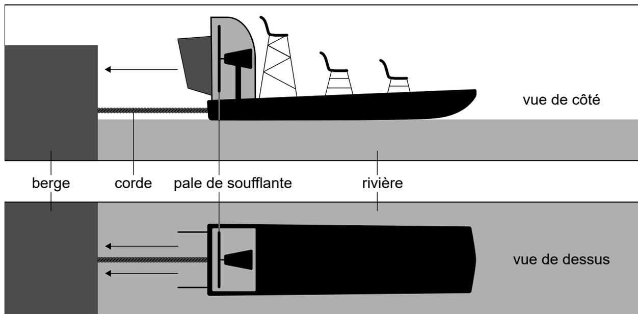
Un hydroglisseur a une pale de soufflante d'un rayon de 1,8m. Cette soufflante peut propulser de l'air avec une vitesse maximum de  $20 \text{ m s}^{-1}$  par rapport à l'hydroglisseur. La densité de l'air est  $1,2 \text{ kg m}^{-3}$ .
