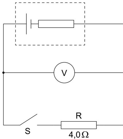
Lorsque S est ouvert, la lecture sur le voltmètre est 12V. Lorsque S est fermé, le voltmètre indique 8,0V.
